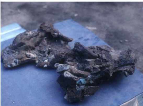
Coppi della copertura della cavea fusi e vetrificati – La Cavea prima dell'incendio
